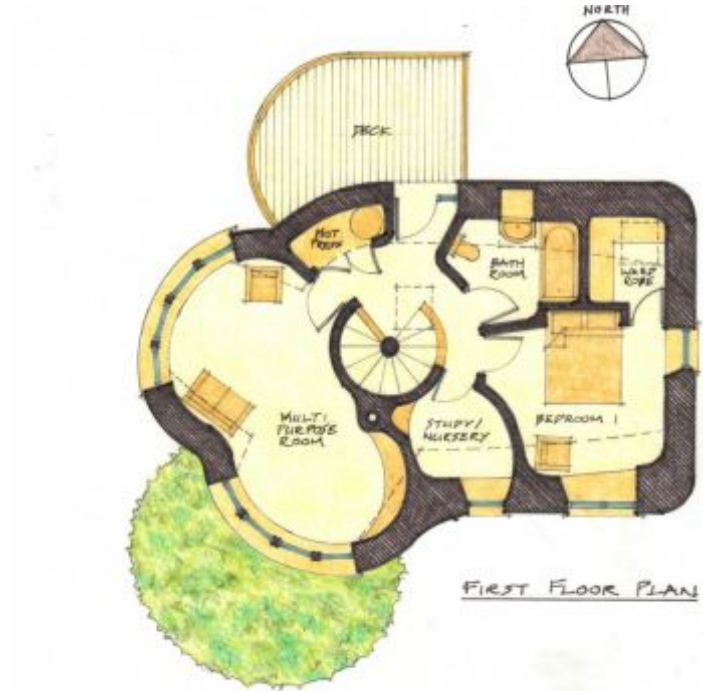
Primer tlorisa: na sliki je primer z ukrivljenimi stenami. Možni so vsi tipi ravnih ali krivih sten. Zunanje stene se izvede masivno, notranje, predelne, pa tanjše. Velika okna obrnemo praviloma na jug, proti severu pa stene še dodatno izoliramo.
