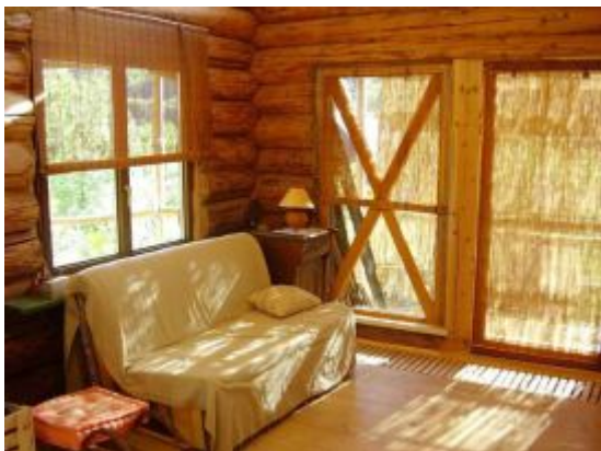
Prelep primer domače brunarice iz Destrnika pri Mariboru. Stene so iz okroglih brun, toplotna izolacija strehe je iz slamnatih bal. Avtor je naravni graditelj Robert Klemensberger.
