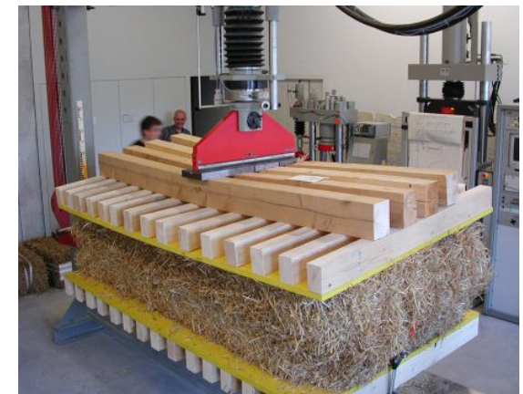
Gradnja večjega objekta in testiranje trdnosti bal v Švici.
